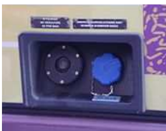
FIGURE 15 – RESERVOIRS DE CARBURANT ET D'UREE SUR UN POIDS Lourd
