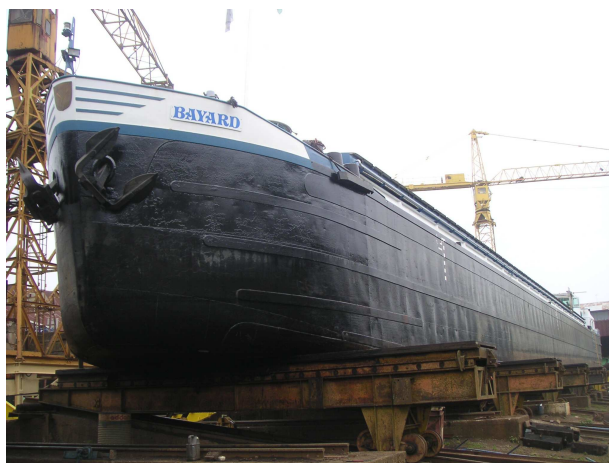
FIGURE 16 - TIRAGE A TERRE D'UN AUTOMOTEUR POUR CARENAGE (CABINET LEBEFAUDE, 2005)
