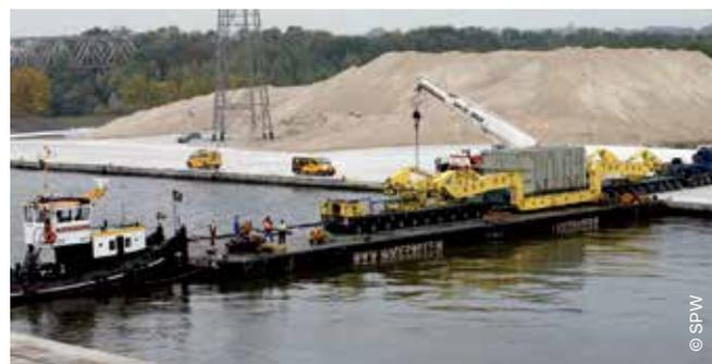
Chargement d'un transformateur électrique de 240 tonnes (4 m de large, 4,60 m de haut et 10,50 m de longueur)
