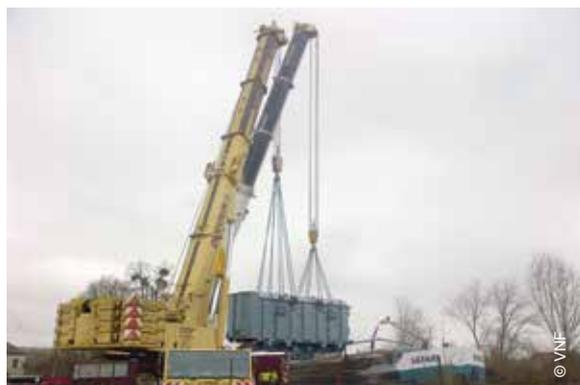
Chargement d'un transformateur électrique de 170 tonnes, sur le canal des Ardennes.
