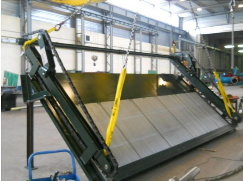
Figure 7 : Exemple de dégrilleur à chaînes
