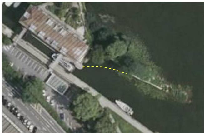
Figure 4 : Implantation de la drôme flottante
