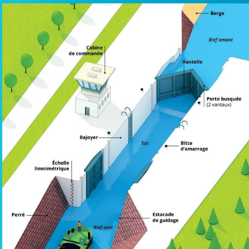
L'écluse comprend un sas dans lequel on peut faire varier le niveau de l'eau. En France, le sas est généralement fermé par deux portes - amont et aval - à volets mobiles appelés « vantaux », exceptionnellement par des portes levantes à guillotine ou d'autres systèmes encore plus rares.
