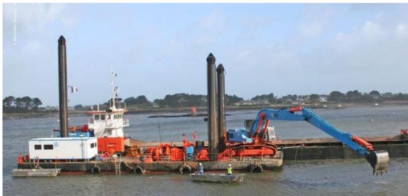
Figure 7 : Illustration d'un dragage mécanique d'une pelle sur ponton (source : VNF)
