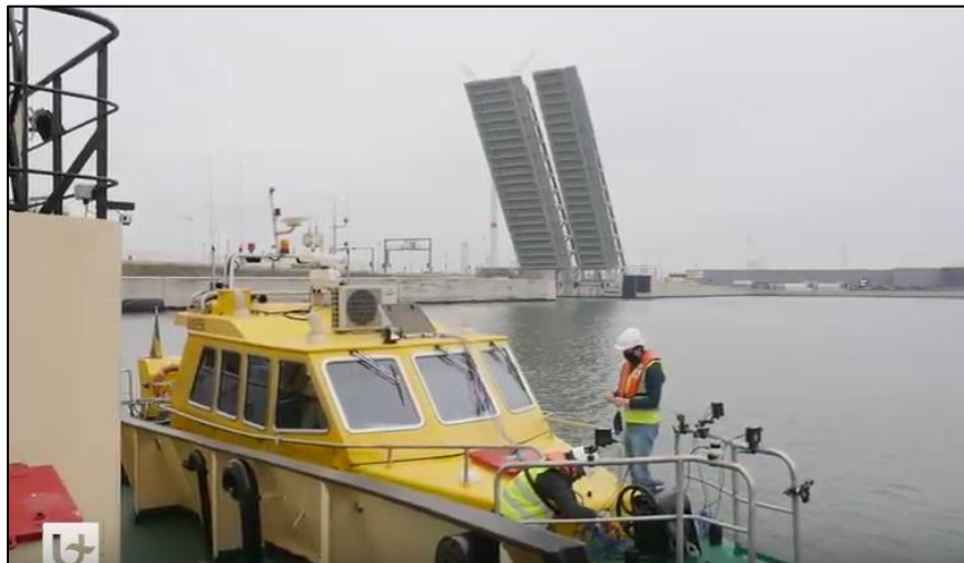
FIGURE 6 : LE TUIMELAAR EQUIPE DE CAPTEURS SONAR 3D
