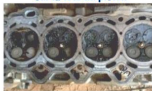
Résidus de carbone sur la culasse
