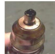
Résidus de carbone sur la buse d'injecteur
