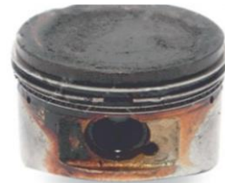
Résidus de carbone sur la tête du piston
