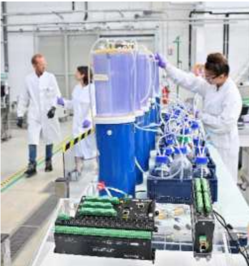
Réacteurs de compostage et de méthanisation instrumentés (étude de biodégradabilité)
