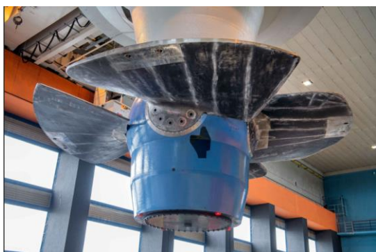
Roue hydroélectrique rénovée ©Ph.Loertscher
